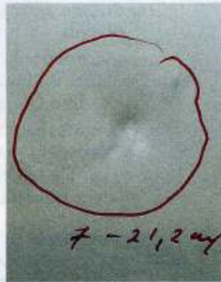
Auch hier zeigt die 20-Millimeter-Kugel mit einem 1,2-Millimeter-Einschlag deutlich Wirkung.
