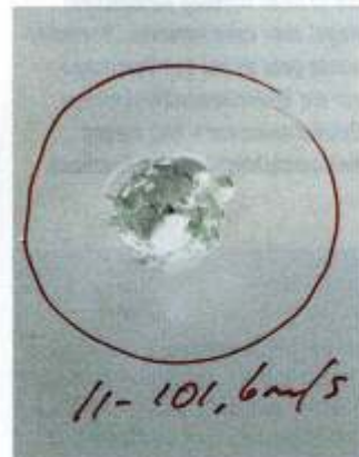
Bei Beschuss mit über 100 m/s (fünftfache realistische Geschwindigkeit) gibt sich GfK geschlagen.
