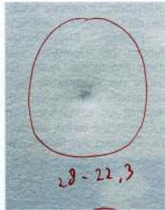
Nach dem Beschuss mit 20-Millimeter-Kugeln wäre auch für die Beschichtung eine Reparatur fällig.
